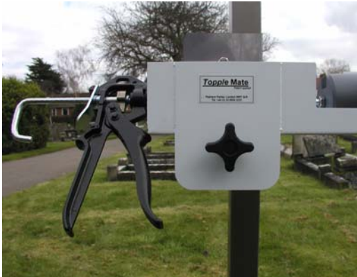
Durch leichtes Zusammendrücken des Handgriffs erzeugen Sie die Prüfkraft.
